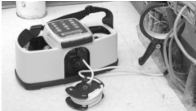
Рис. 12 – индукционный зажим подключен к проводнику
