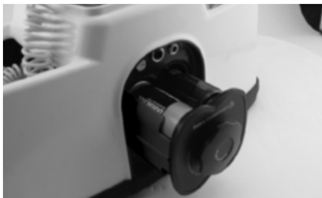
Рис. 6 – извлечение аккумуляторного отсека
